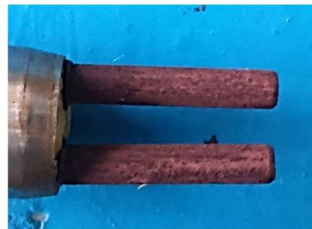
Рисунок 7 – Фото електродів датчика корозії, вилученого з трубопроводу підживлення 21.11.16 РК «Молодь»
