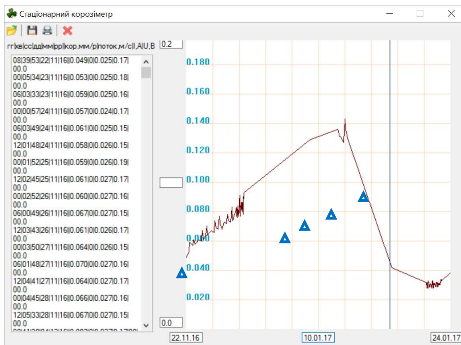
Рисунок 12 - Залежності швидкості корозії від часу на РК «Нивки», зворотній трубопровід 2.
