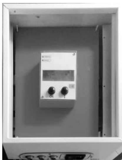
Рисунок 2 – Стационарний корозиметр ІК-4с.
