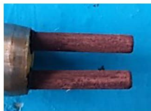
Рисунок 16 – Фото електродів датчика корозії, вилученого з трубопроводу підживлення 21.11.16 РК «Молодь»
