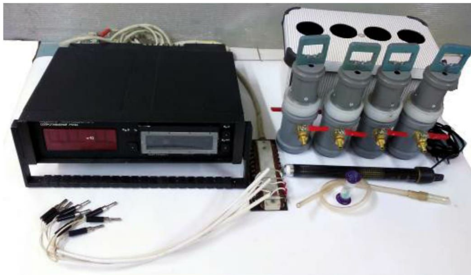
Рисунок 4 – Лабораторний корозиметр Р5126 з набором комірок для визначення корозивності.
