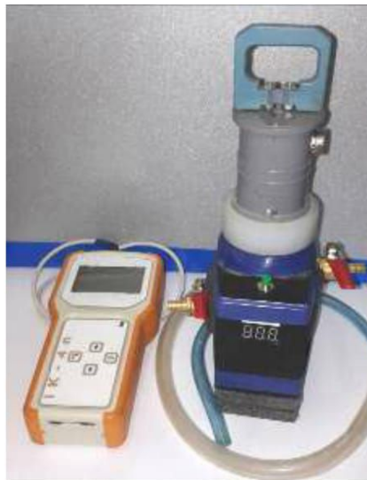
Рисунок 5 – Портативний корозиметр ІК-4п з електрохімічною коміркою.
