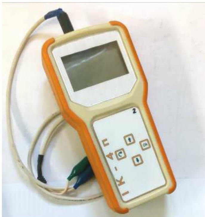
Рисунок 3 – Портативний корозиметр ІК-4п.
